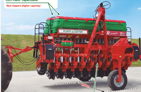
Cabeçalho com levante hidráulico Hitch - hydraulic lifting
