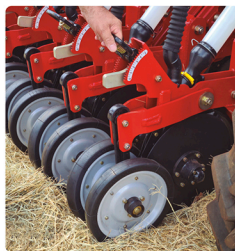
Disco duplo defasado 15" x 16" Double Disk 15" x 16"
